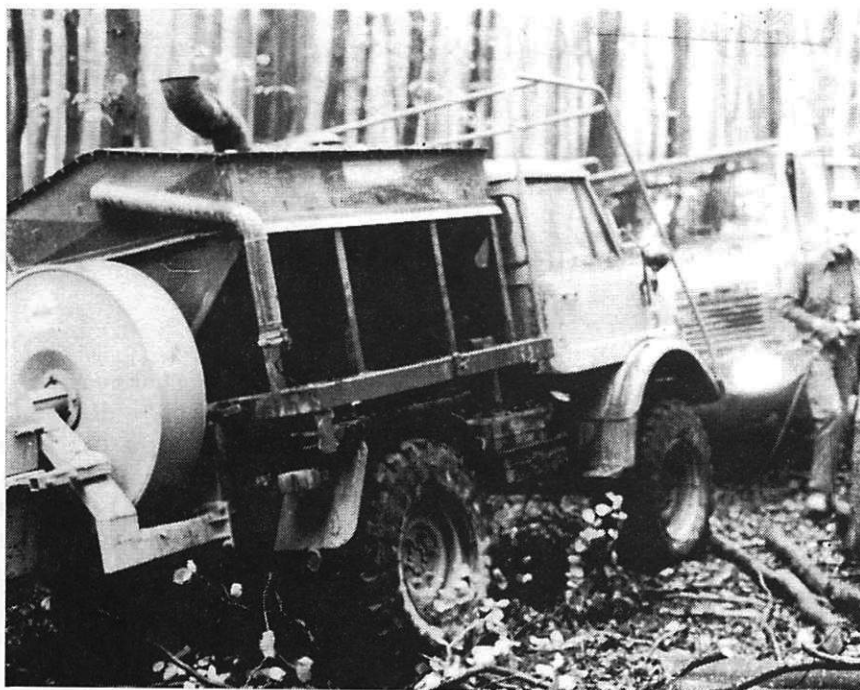
Mit einer Seilwinde wird der Unimog herausgezogen
