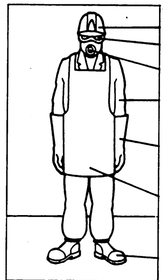
Von der Chemieindustrie für die Tropen empfohlene Schutzkleidung (Schutzhelm, Augenschutz, Gasmask, einteiliger Arbeitsanzug, Schutzhandschuhe, Gummischürze, Arbeitsschuhe).
